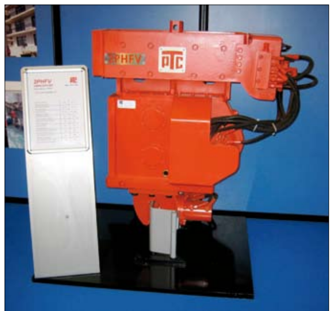
Alcuni modelli di vibroinfessori ad alta frequenza, con ampiezza variabile, per l'applicazione specifica sugli escavatori, presentati all'ultimo Samoter di Verona
