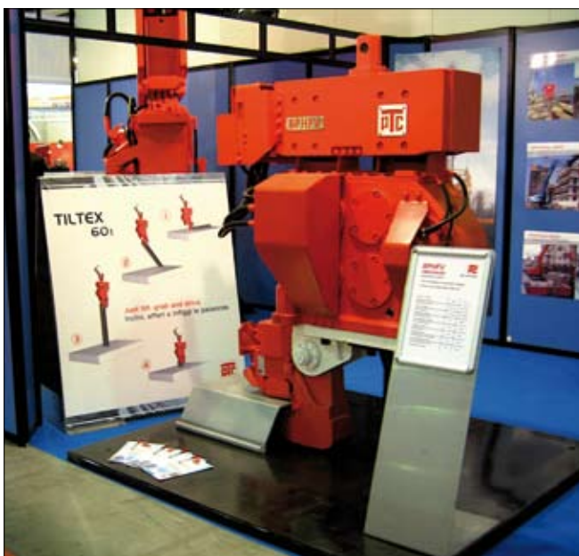
Alcuni modelli di vibroinfessori ad alta frequenza, con ampiezza variabile, per l'applicazione specifica sugli escavatori, presentati all'ultimo Samoter di Verona
